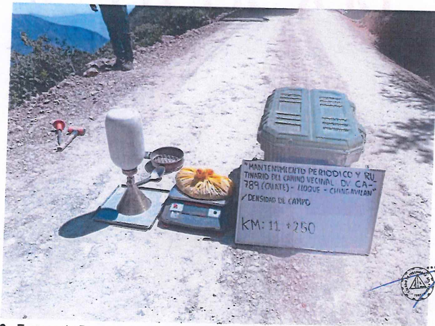
FIGURA N° 46. Ensayo de Densidad de Suelo en Campo. Progresiva 11 + 250 (Método del cono de arena).
