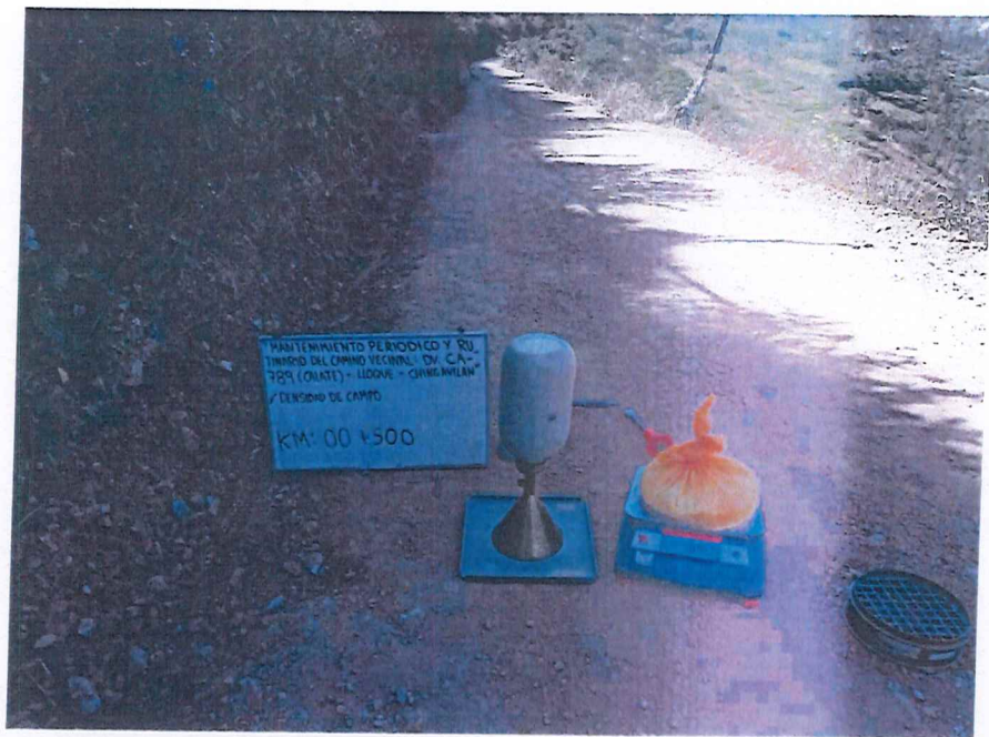
FIGURA N° 3. Ensayo de Densidad de Suelo en Campo. Progresiva 00 + 500 (Método del cono de arena).
