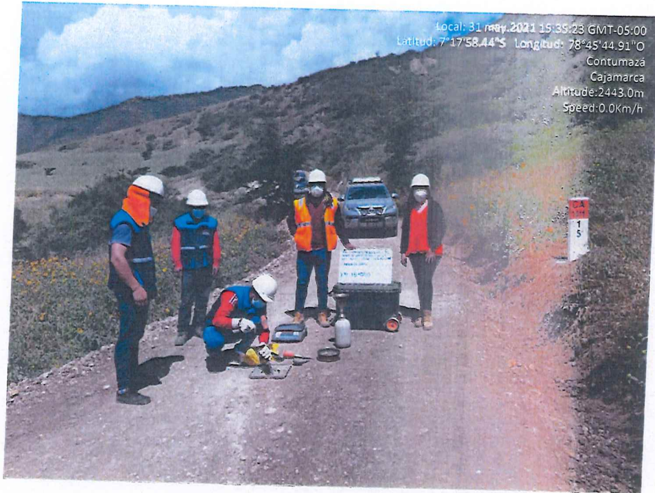
Ilustración 11. Realizando la prueba de densidad en campo.
