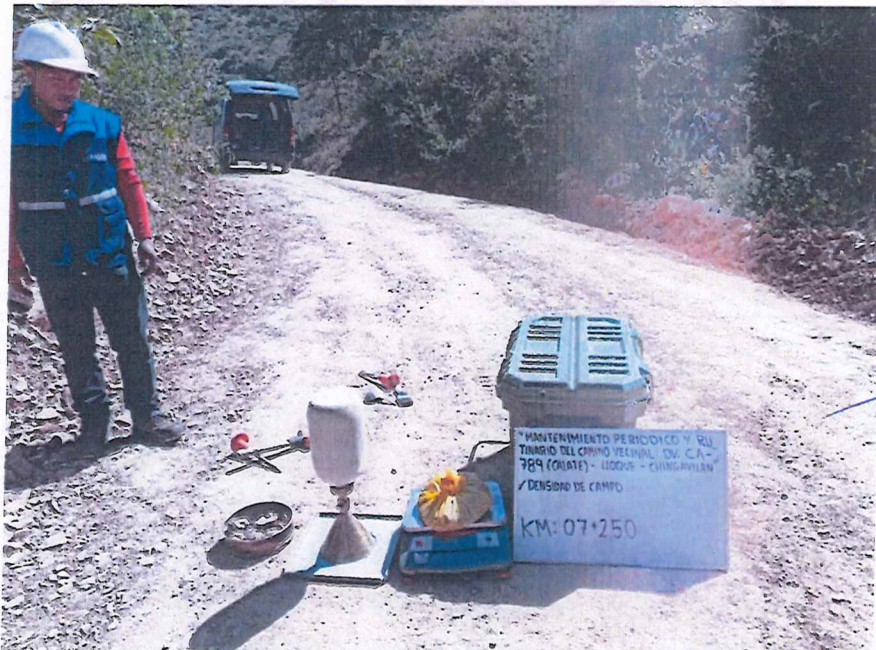
FIGURA N° 30. Ensayo de Densidad de Suelo en Campo. Progresiva 07 + 250 (Método del cono de arena).
