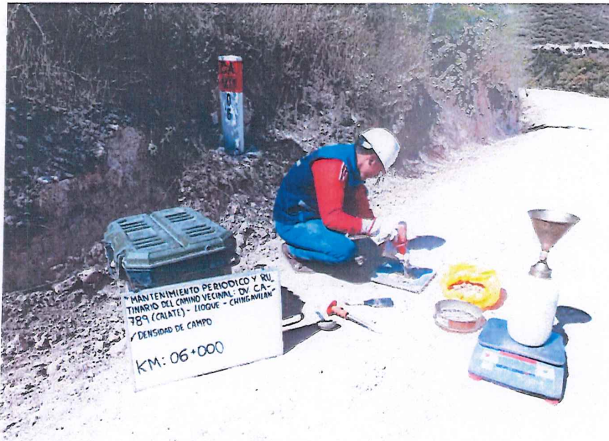
FIGURA Nº 25. Ensayo de Densidad de Suelo en Campo. Progresiva 06 + 000 (Método del cono de arena).
