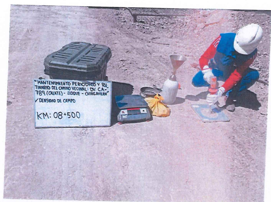
FIGURA N° 35. Ensayo de Densidad de Suelo en Campo. Progresiva 08 + 500 (Método del cono de arena).
