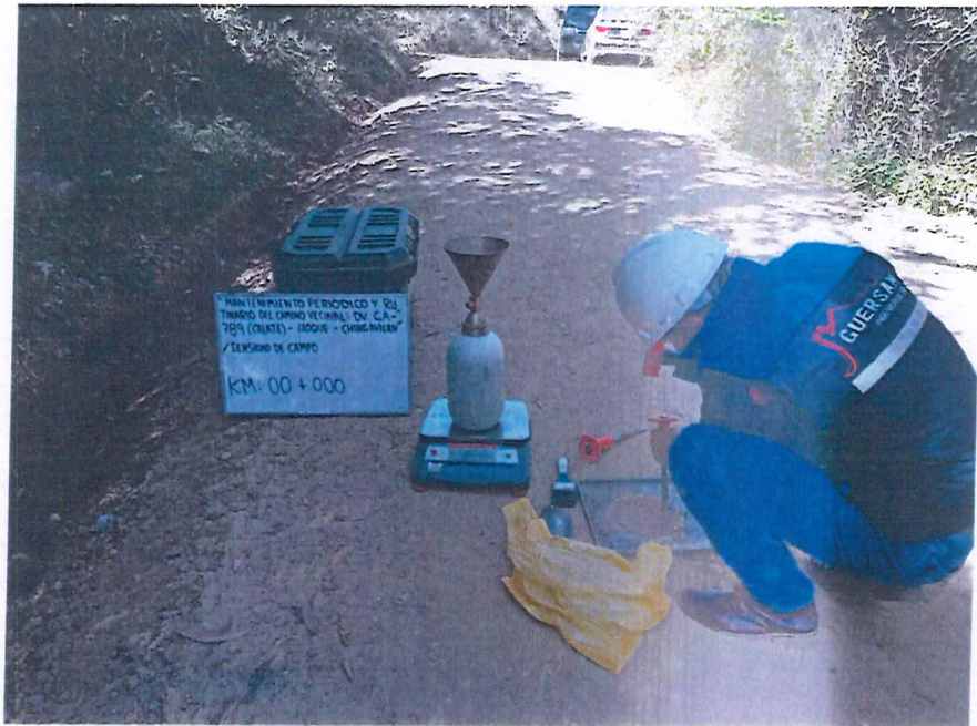
FIGURA N° 1. Ensayo de Densidad de Suelo en Campo. Progresiva 00 + 000 (Método del cono de arena).
