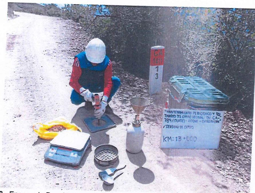
FIGURA N° 53. Ensayo de Densidad de Suelo en Campo. Progresiva 13 + 000 (Método del cono de arena).
