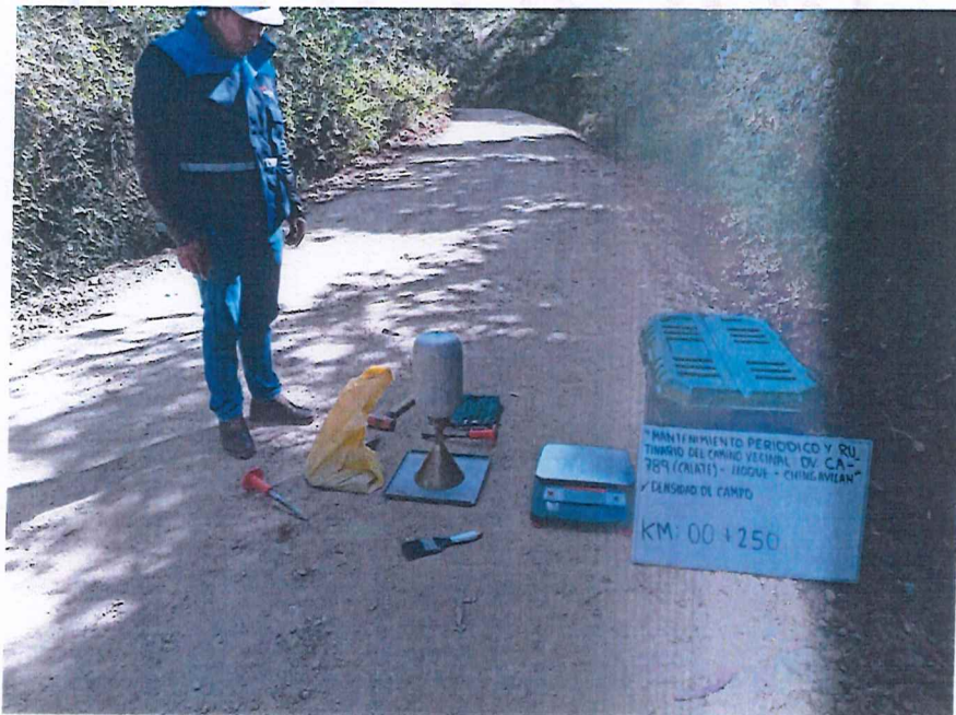
FIGURA N° 2. Ensayo de Densidad de Suelo en Campo. Progresiva 00 + 250 (Método del cono de arena).
